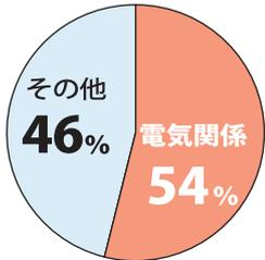
阪神淡路大震災や東日本大震災において発生した火災の過半数は、電気が原因でした。近年感震ブレーカーの設置・配布に、国をあげての取り組みが始まっております。本機1台の設置で家中の電気をすべて落とすので、電源がONになったままの電気機器からの出火や、損傷した電気コードに通電することによる火災を防ぐことができます。
